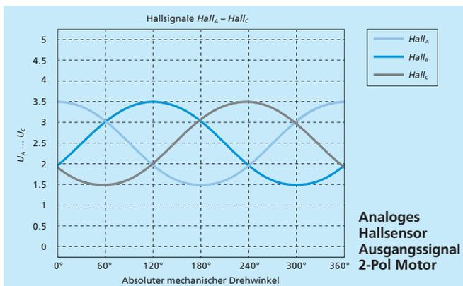
Die analogen Hallensensoren können aufgrund der höheren Auflösung auch zur genauen Drehzahl- oder zur Positionsregelung eingesetzt werden und sind damit eine beson-
