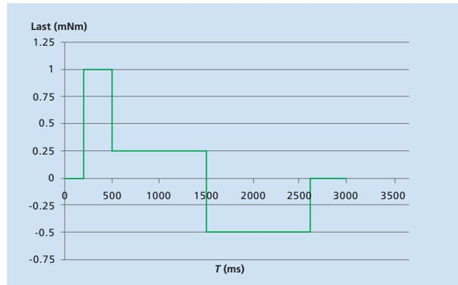
Im vorliegenden Beispiel wird der AM1524, aus Gründen der Vorgabe des Durchmessers von max. 15 mm, in der Anwendung eingesetzt. Sein Massenträgheitsmoment wurde in der Lastberechnung berücksichtigt.
