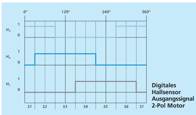
Außerdem sind als Option in der Regel analoge Hallensensoren verfügbar.
