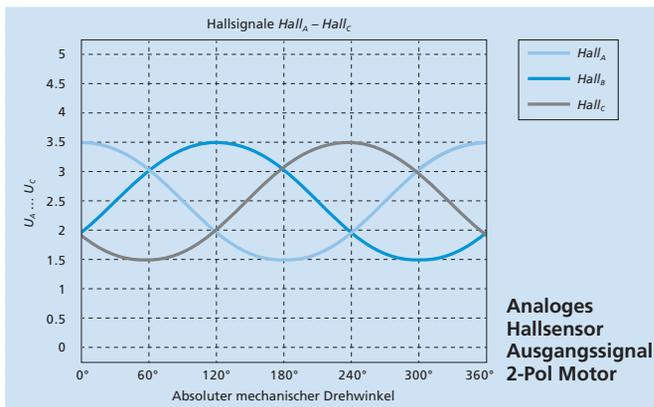
Diese Sensoren können in vielen Anwendungen die Notwendigkeit eines hochauflösenden Encoders ersetzen und die grundlegenden Kommutierungssignale für die bürstenlosen DC-Servomotoren in Kombination mit FAULHABER Motion Controllern bereitstellen.
