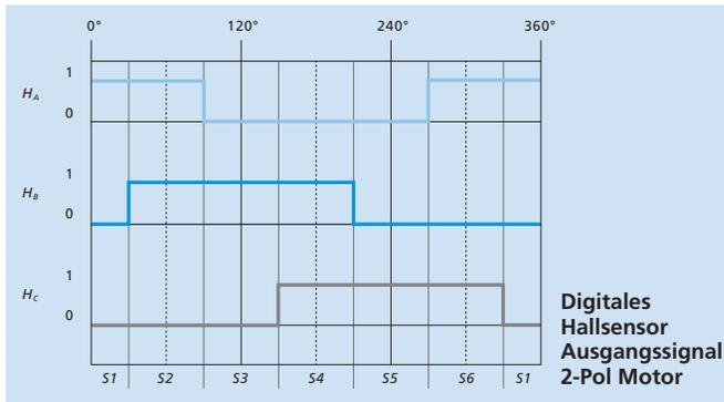
Optional sind die meisten FAULHABER bürstenlosen DC-Servomotoren mit analogen (linearen) Hallensoren erhältlich.
