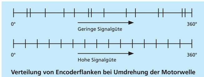
Der wichtigste Parameter für die Signalgüte der FAULHABER Encoder ist der Phasenfehler ( $\Delta\phi$ ). Ist der Phasenfehler gering, gibt der Encoder gleichmäßige Signale wieder. Während die magnetischen FAULHABER Encoder bereits eine hohe Signalgüte mit einem Phasenfehler von rund  $45^\circ$  aufweisen, bestehen die optischen FAULHABER Encoder mit einer besonders hohen Signalgüte mit einem Phasenfehler von rund  $20^\circ$ . Optische Encoder sind in der Regel noch genauer als magnetische.
